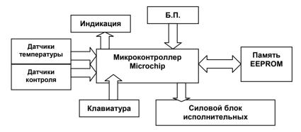
Термодатчик изготавливается на интегральных микросхемах производства Microchip, Dallas semiconductor, Analog Device. Выбор типа микросхемы зависит от точности получаемых данных. Информация с датчика в цифровом коде по последовательному интерфейсу передается в микропроцессор.
